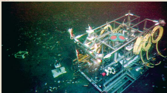
相模湾初島沖水深1,170mに設置された深海底総合観測ステーション
