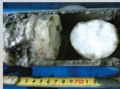
日本海・新潟沖の水深約900mの海底で採取されたメタンハイドレートの塊
