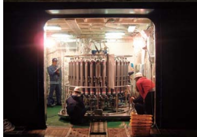
CTDによる観測は24時間、休みなく続く。CTD（Conductivity Temperature and Depth profiling system）はクレーン・ウインチによってつり下げられ、沈みながら水温と塩分を高精度で測定する。CTDセンサーの周りにRMS（Rosette Multi Sampler）の採水ボトルが36本並び、引き上げながら異なる深度で海水を採取する。1回の観測に4時間ほどかかる
