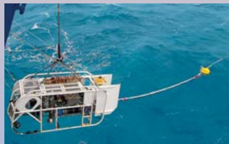
電流発生装置と電極を装備した「ディープ・トウ」
