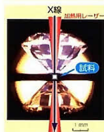
図5 レーザー加熱ダイヤモンドアンビル超高压発生装置の概念図 地球上で最も固い物質であるダイヤモンドを加压して超高压状態を生み出し、レーザーで加熱して高温状態にして、X線により構造解析を行う
