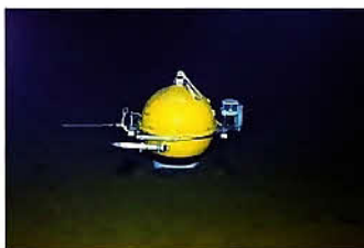
図2 深さ4400mの深海底に設置されているBBOBS (FP6観測点)
