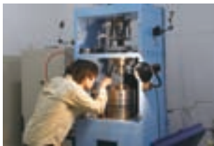
摩擦試験装置の開発 地下深部の複雑な地震断層滑り運動を再現・制御する流体制御型摩擦試験装置摩擦試験機の開発を行いました。
