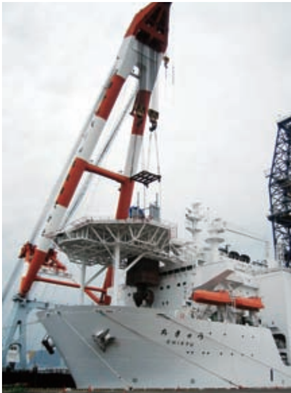
図1：神戸港でのスラスタコンテナ引抜き工事
