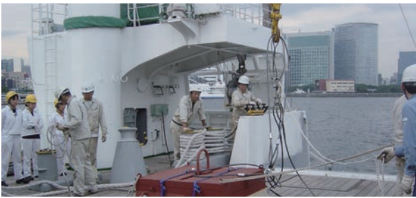
図3. 停泊中の海鷹丸でのアンカー投入試験
