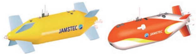
図2. 左：海底資源探査用巡航型AUV / 右：地球科学調査用巡航型AUV
