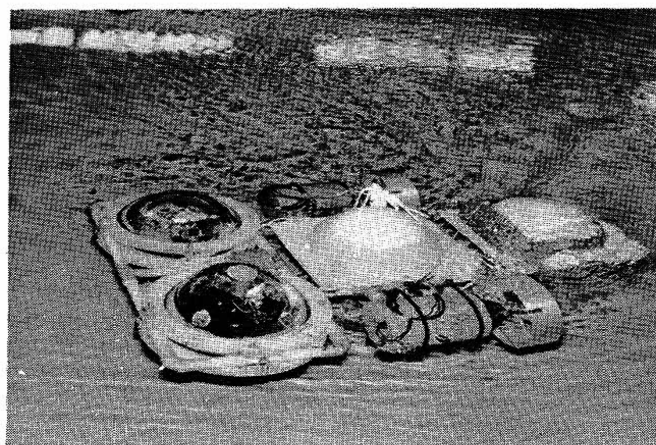
写真4 試験中の自航式カメラ
