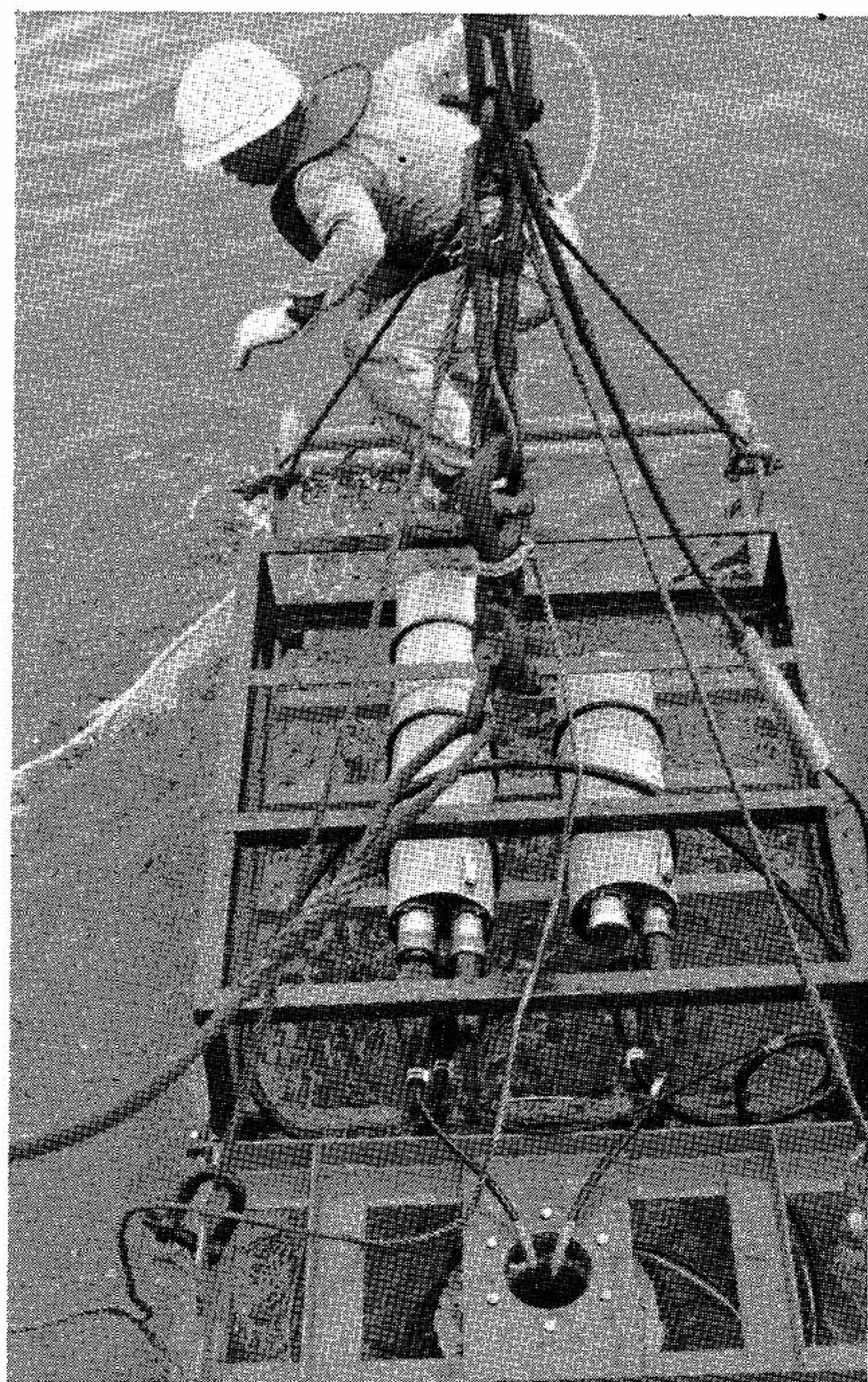
写真1 試験システムのフレーム発進、揚収作業 Plate 1 Launch (L) and recovery (R) operation of the frame
