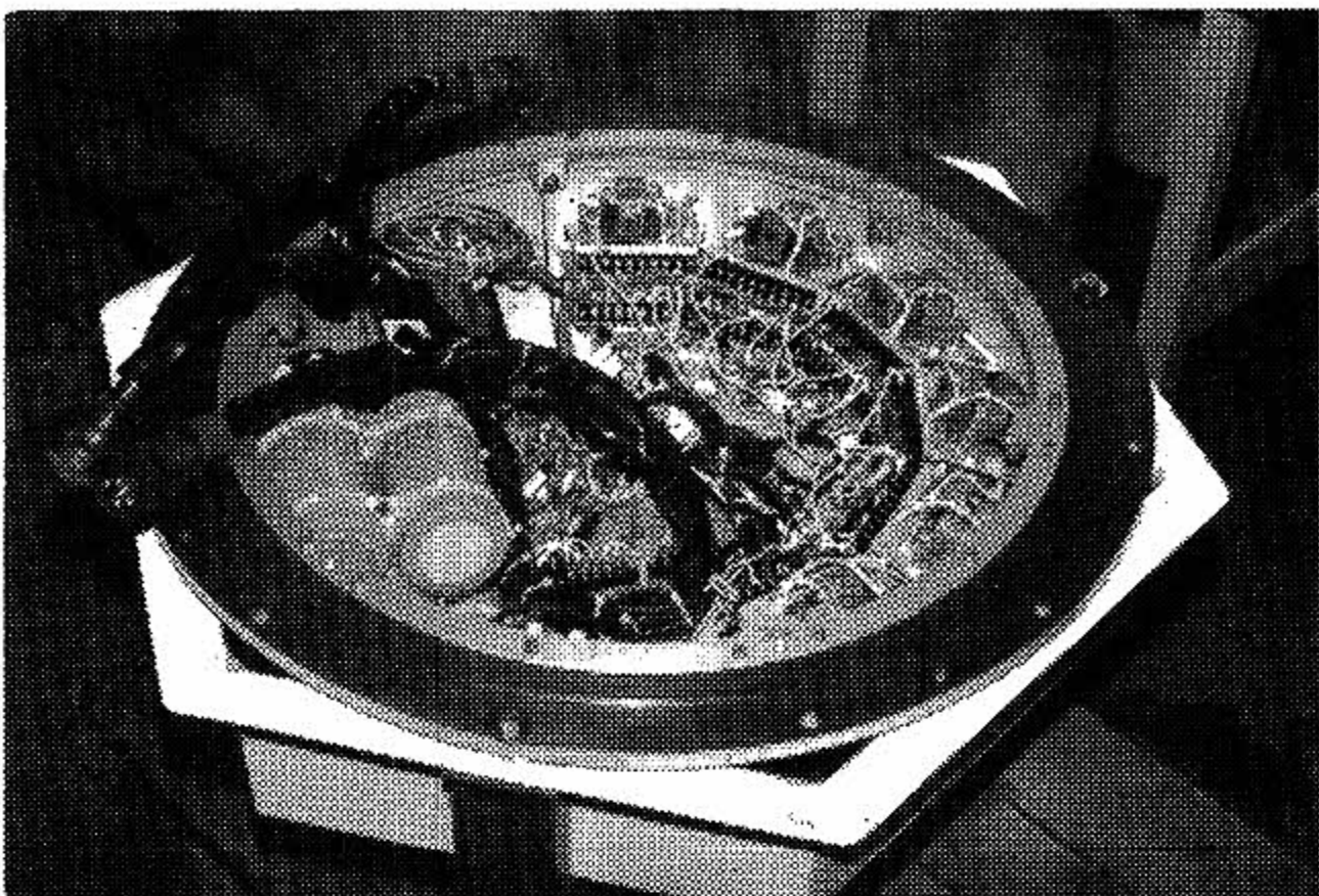
写真1 インバータ実装状態 Interior of inverter
