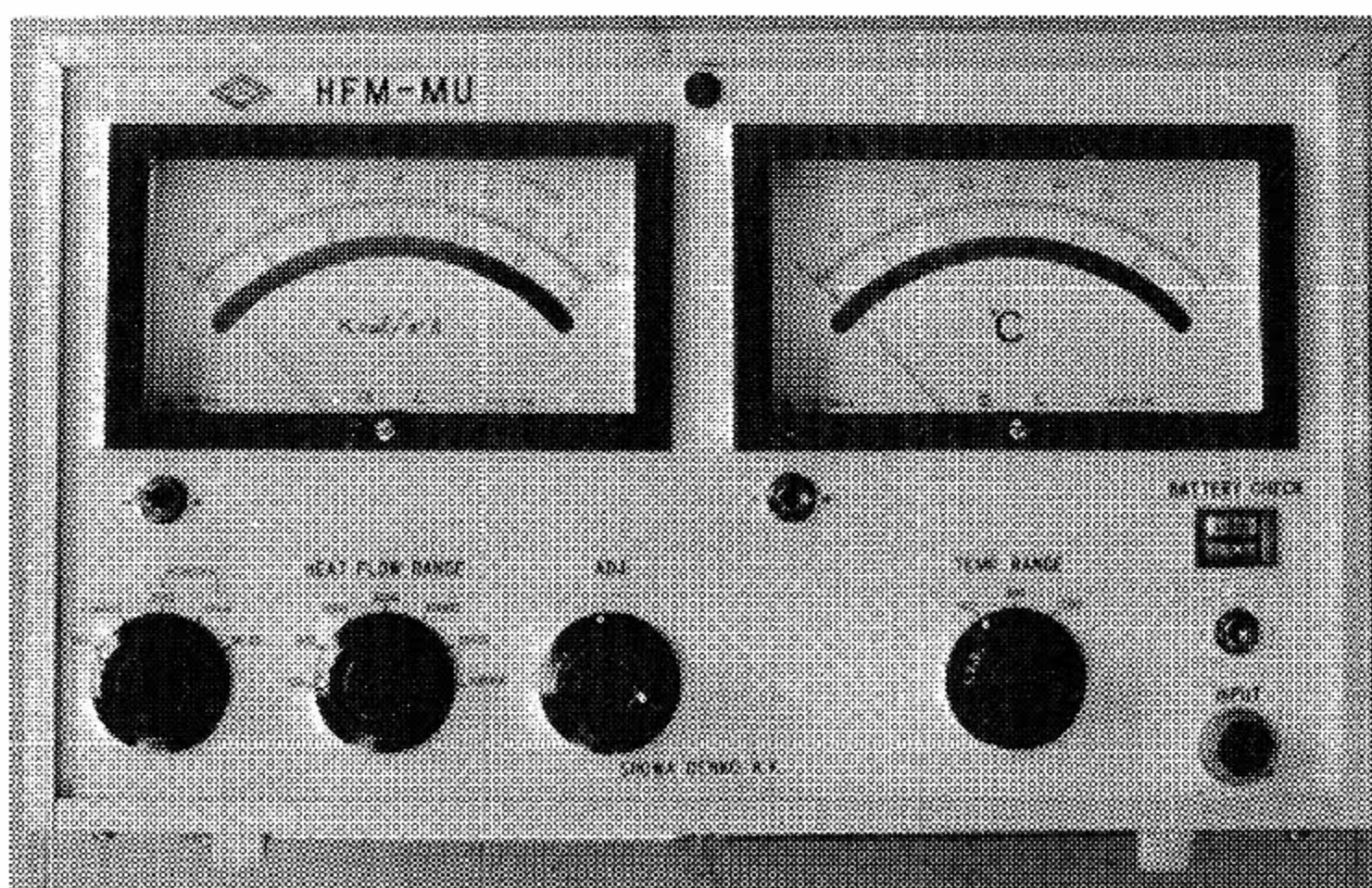
写真 7 熱流束計 (HFM-MU) Heat flux meter
