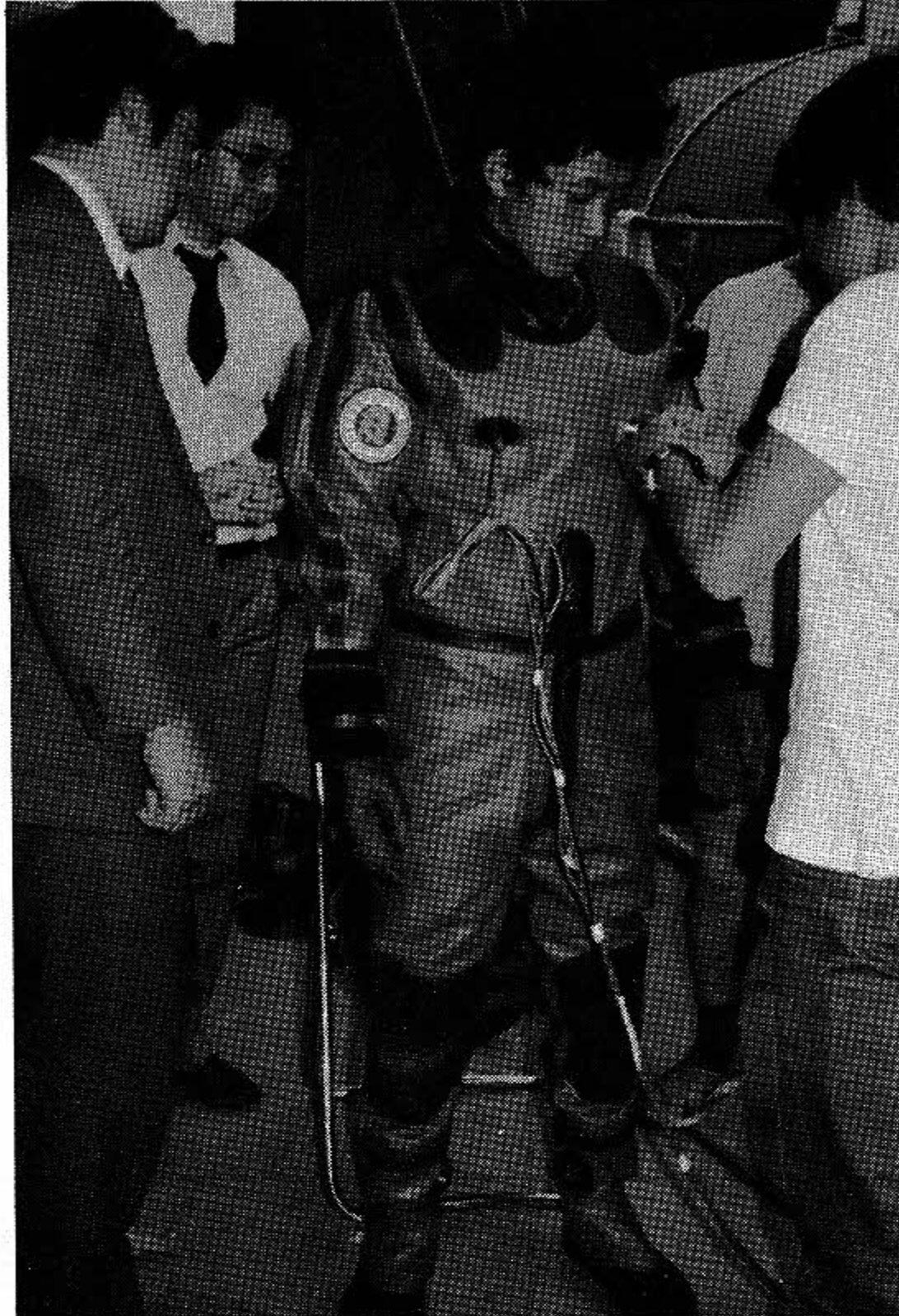
写真1 テストに用いたドライスーツ Constant volume type diving suit for test
