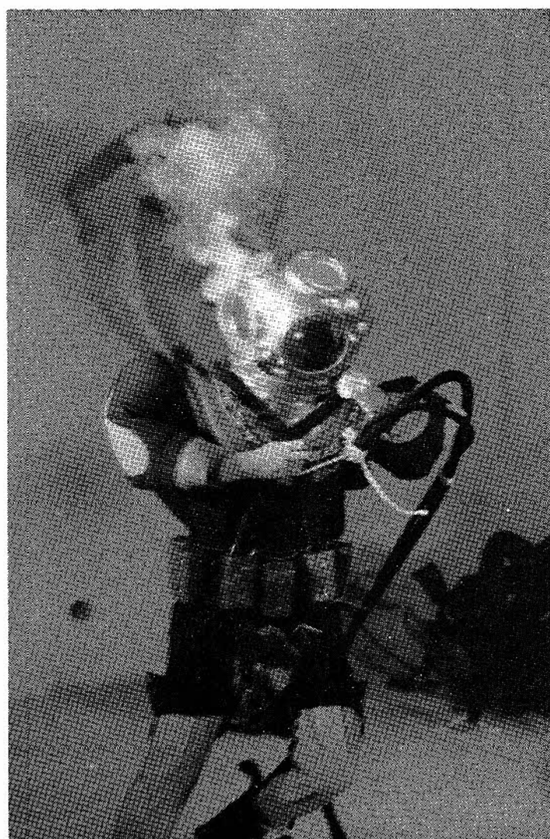
写真4 ドライスーツの水中状態 Swelled and squeezed section of dry suit under water
