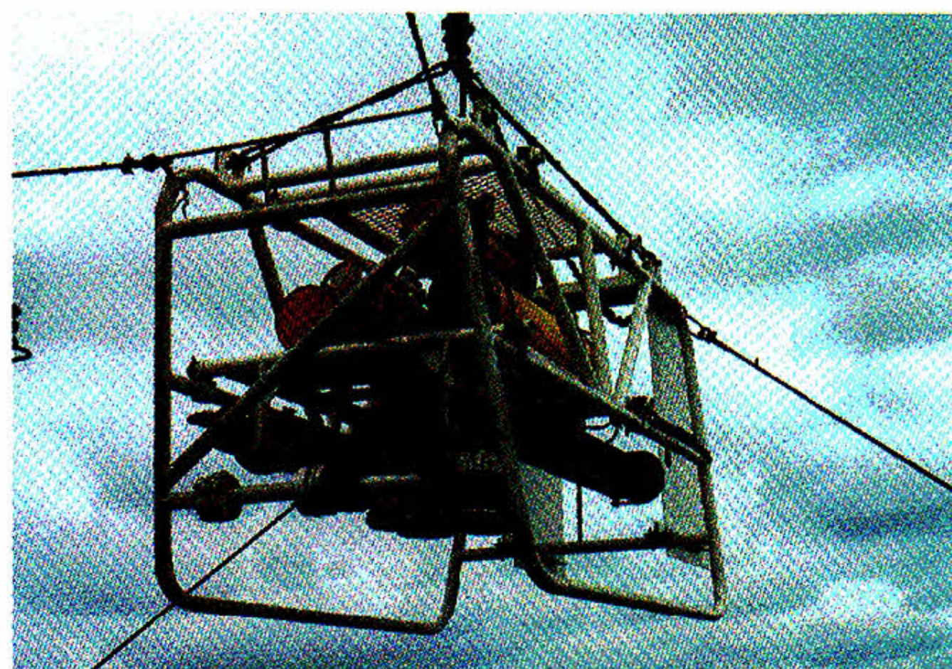
(b) 各種ソーナー類を装備した曳航装置 「DEEP SEA SURVEYOR」
