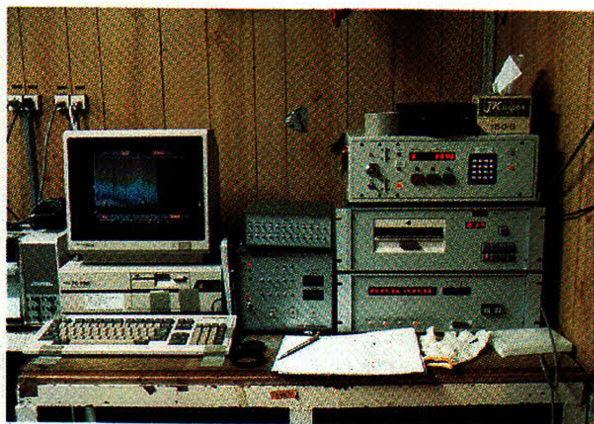
写真12 船上装置。右上から船上ユニット，カートリッジMT，カートリッジMT用インターフェース，中央に昇降運動制御のための指令装置，左にデータモニター用パーソナルコンピュータ Onboard equipments. Right; deck unit, cartridge MT and its interface Center; vehicle motion controller Left; desk top computer for data monitor
