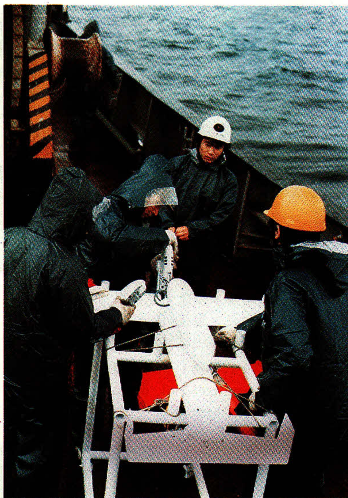
写真14 植物プランクトン等の海中浮遊粒子からの蛍光，散乱光を計測するための光センサーを搭載した大型実用試験機 The large vehicle which carries CTD and optical sensors for biological measurement
