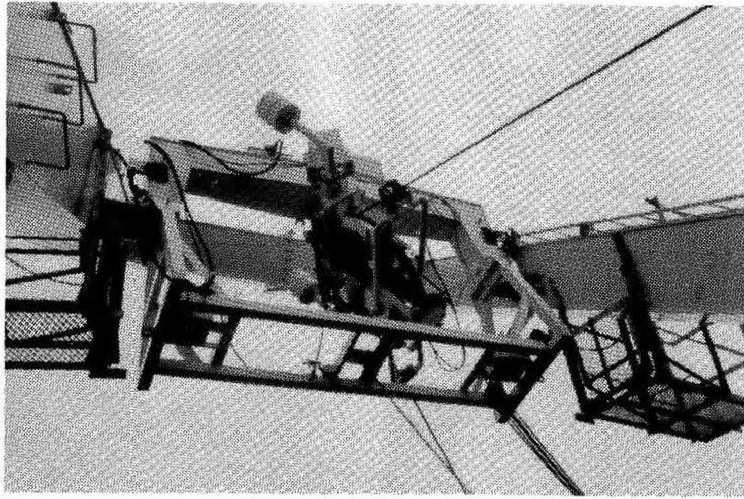
図1(a) 専用のAフレームに設置し、深海曳航中の ジンバルシーブ2号機
