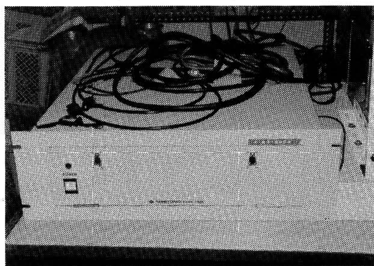
写真5 光通信装置船上部 (光送信器)
