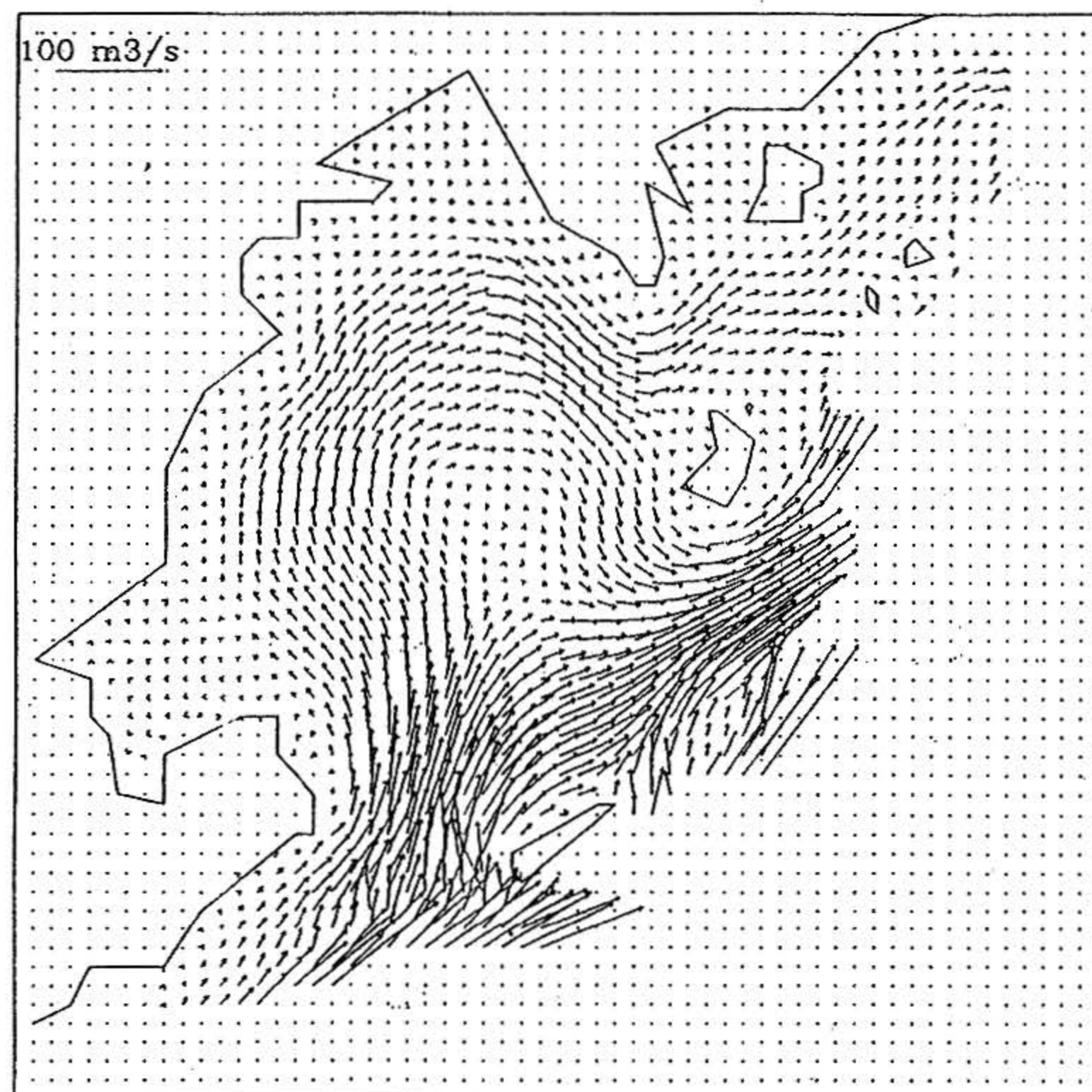
図 15 風による流れのシミュレーション結果 (風速10m/s, 風向45° )
