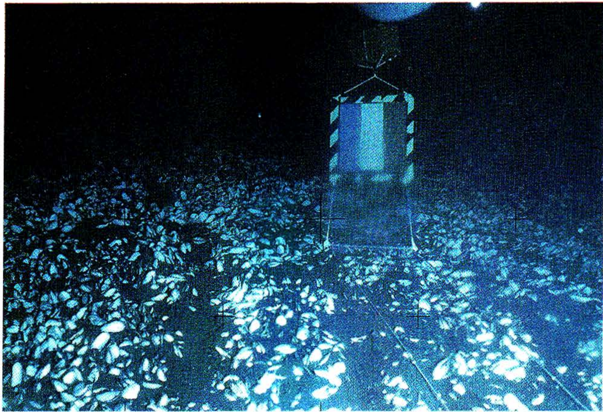
写真 7 ランプ性能試験状況（中央に色見本が見られる。）
