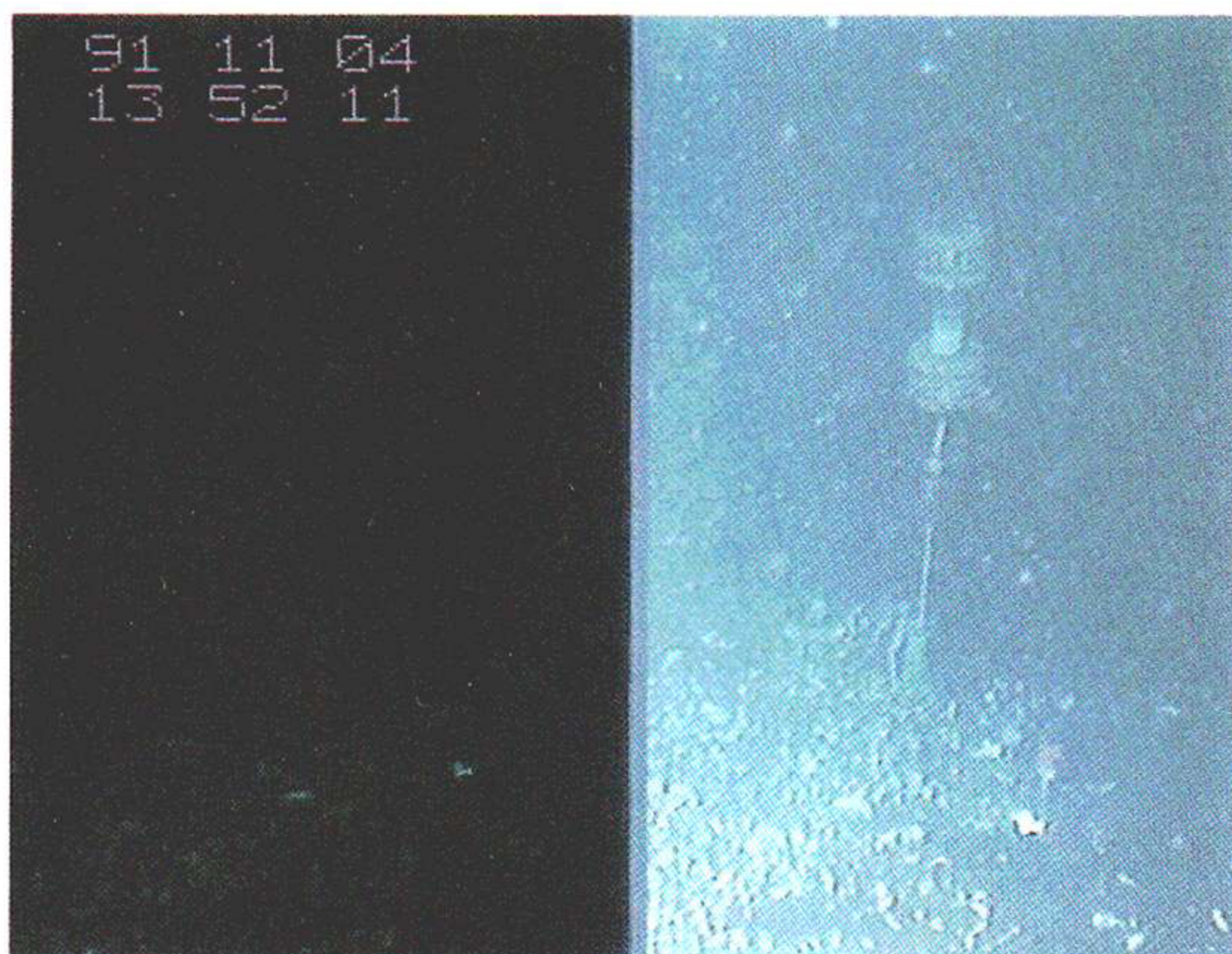
写真7 超高感度・高改造度水中TVカメラとCCD TVカメラの比較映像写真
