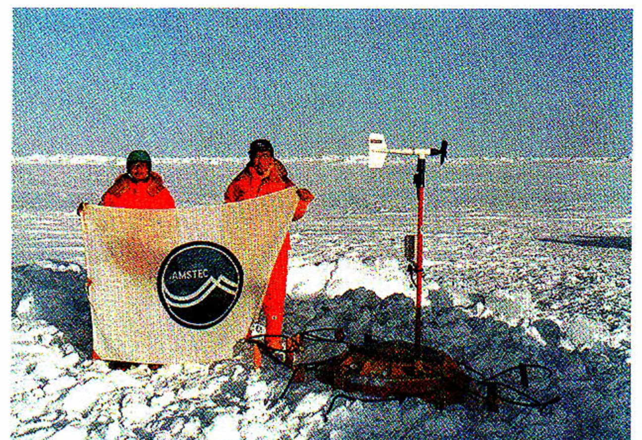
写真 1 IOEB 2 号機の設置を完了したところ 〔ブイ上部の 2 つの黒い丸が送信アンテナ〕
