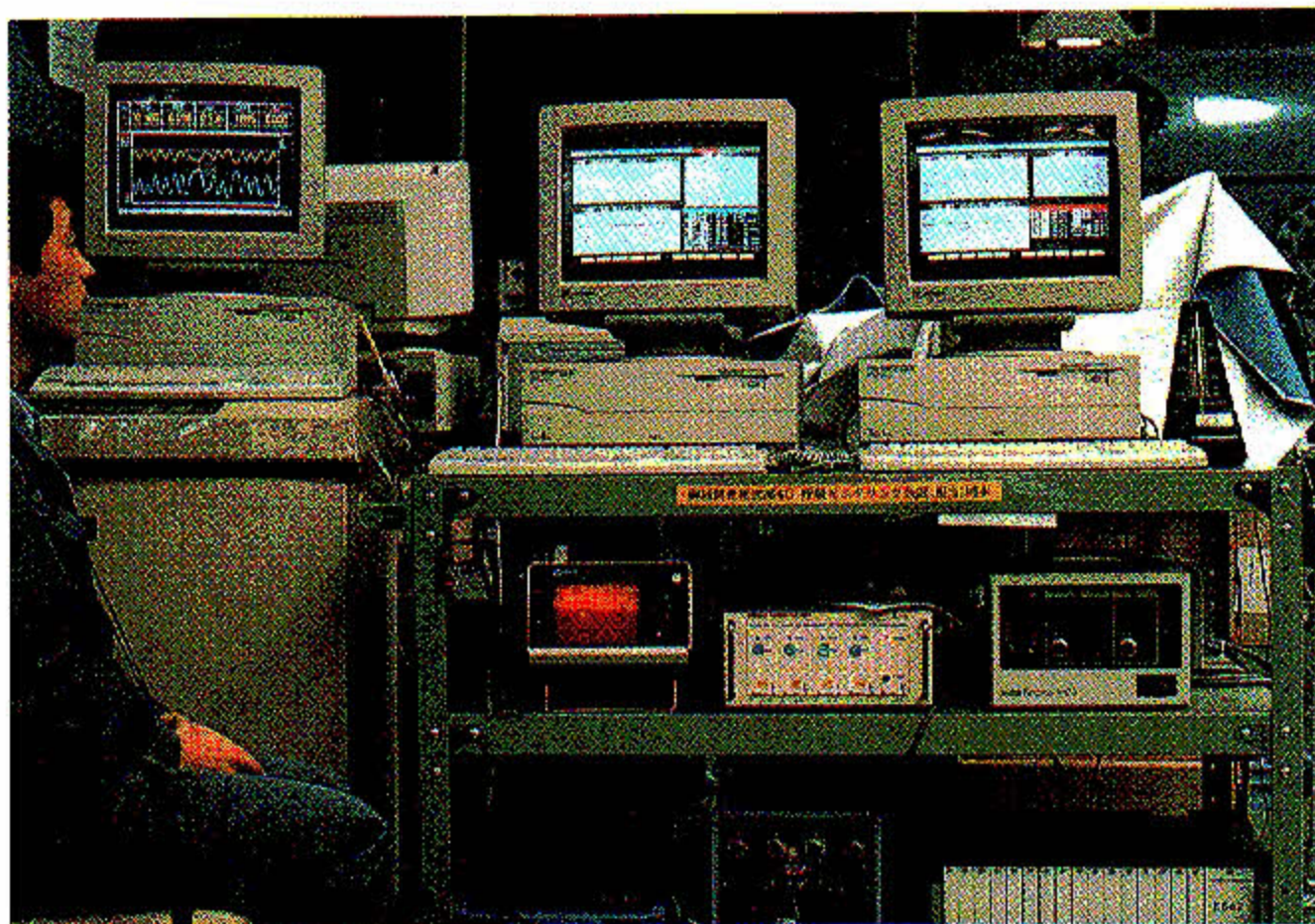
写真5 呼吸モニタリング装置のチェンバー外機器 左：高圧状態の呼吸ガス分析用質量分析計 右上：監視用及び解析用コンピュータ 右下：心拍計，圧力変換器，大気圧用呼吸ガス分析計， 温湿度用アンプ
