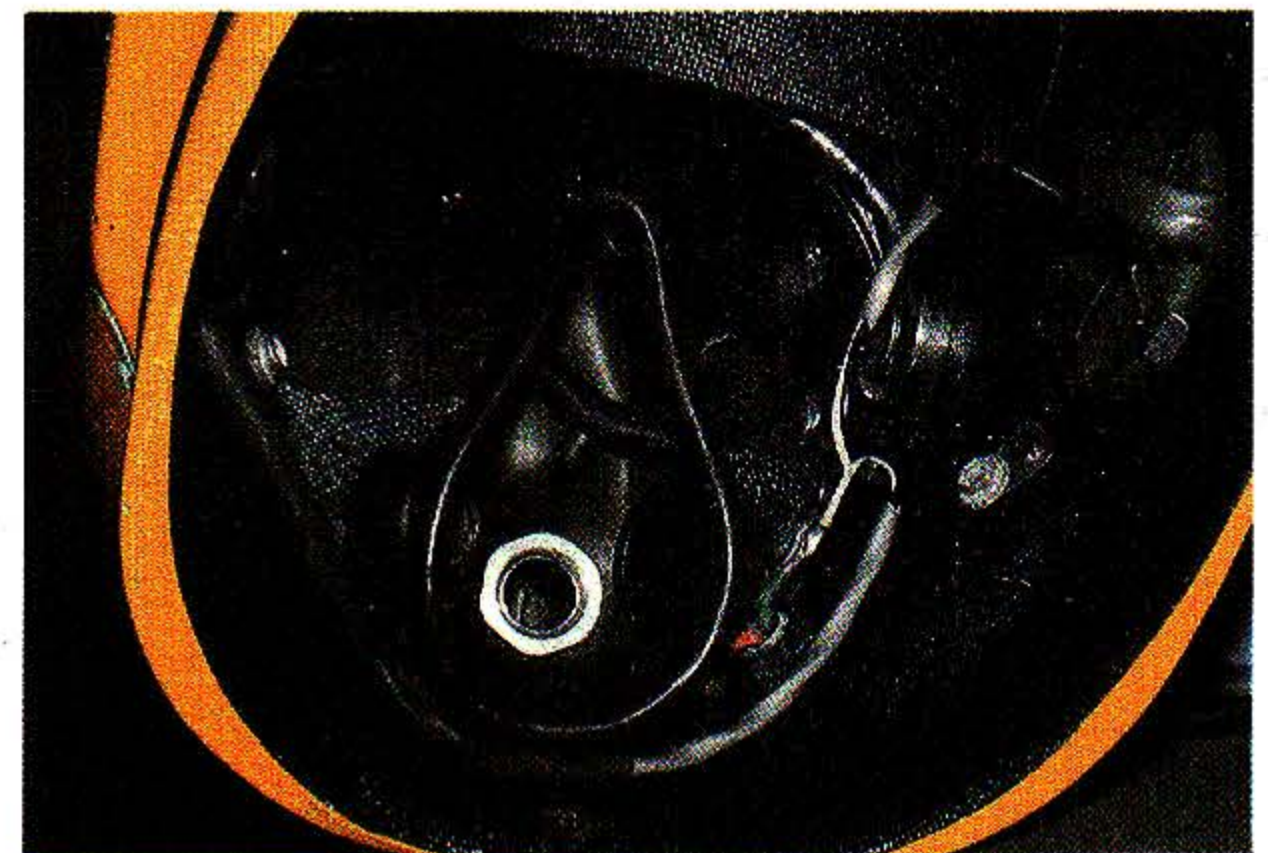
写真1 ハードハット内の口鼻マスク Photo 1 Oral nasal in a SUPERLITE 17B helmet
