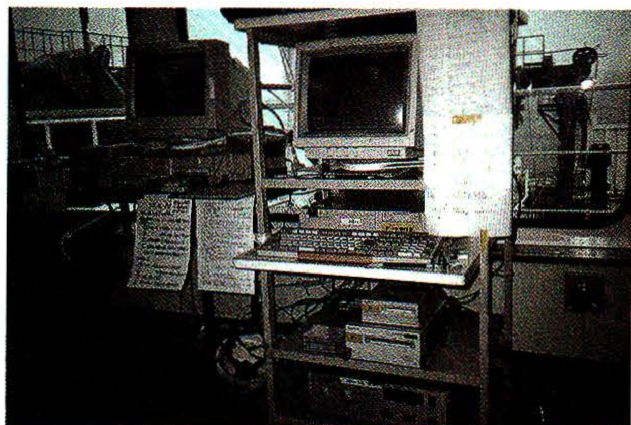
写真1 WOCE観測においてCTD観測で使ったコンピューターシステム。右がデータ取得用、左がデータ解析用のものである。「かいよう」の総合指揮室において撮影。
