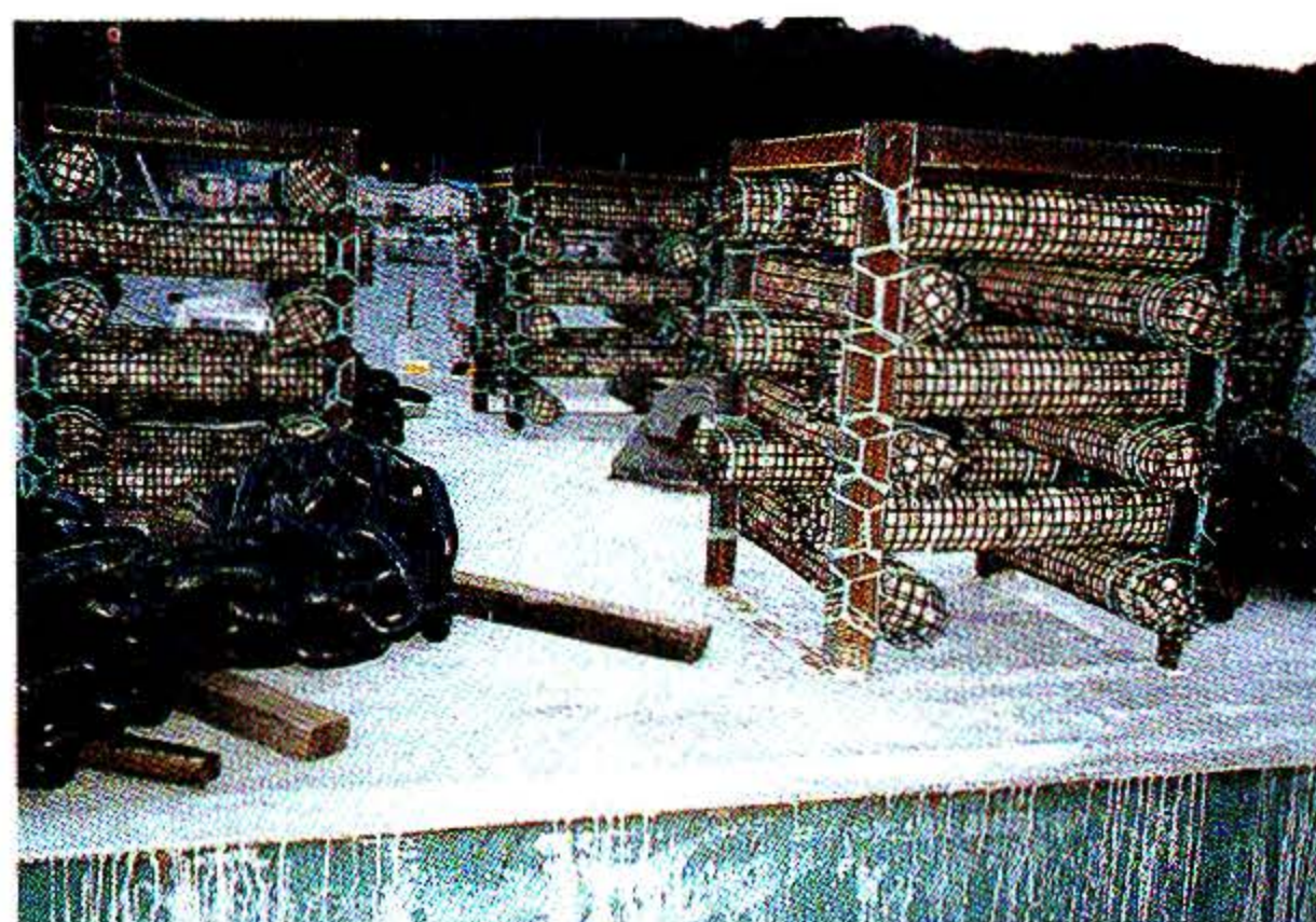
写真9 バランスウエイトに取り付けられた模型魚礁
