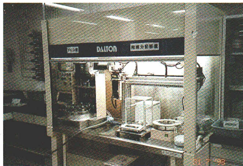
写真13 クリーンベンチ内の触媒分配装置とターゲットプレス器 Photo 13 Catalyst dispenser and target press in a clean bench
