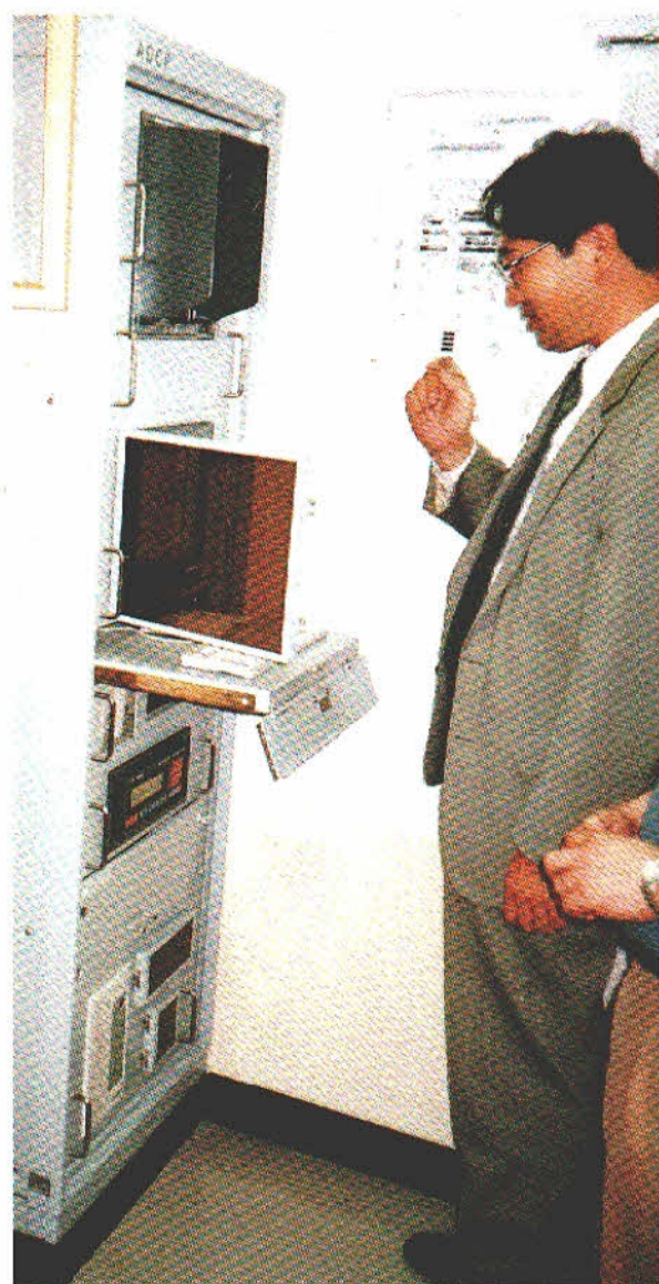
図5 船橋のADCP設定・記録部
