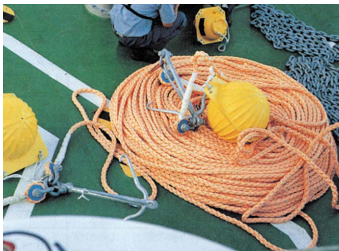
写真1-a からみ索のロープ及びスマル
