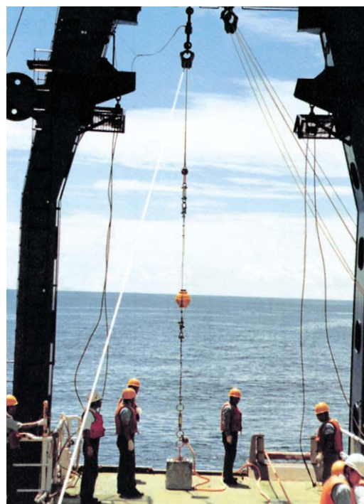
写真 2-b 吊り下げられているトランスポンダーとシンカー
