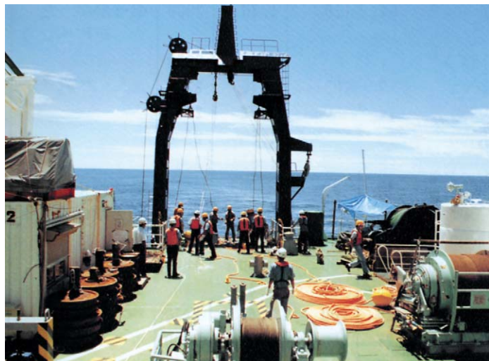
写真 2-a からみ索の展開作業
