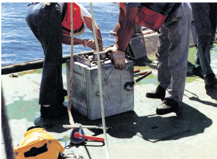
写真1-c からみ索に取り付けるシンカー
