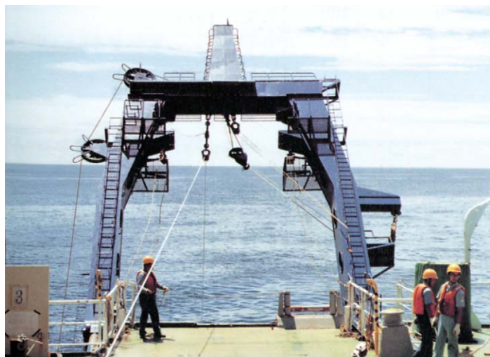
写真 2-c からみ索の曳航中
