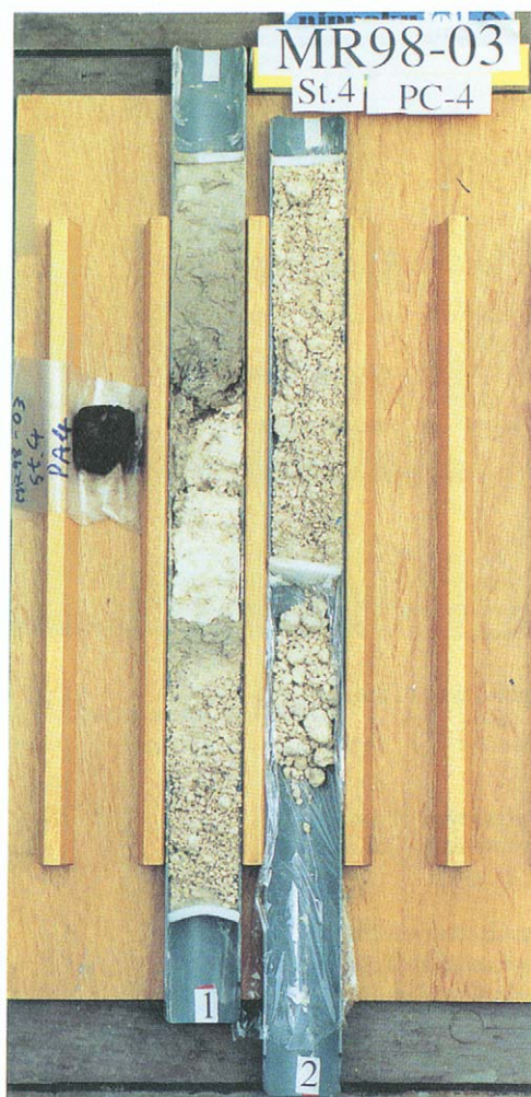
写真5 MR98 - 03, PC - 4コアとアシュラによって回収されたマンガンノジュール Photo 5 MR98 - 03, PC - 4 core and a manganese nodule recovered with the Ashura corer.
