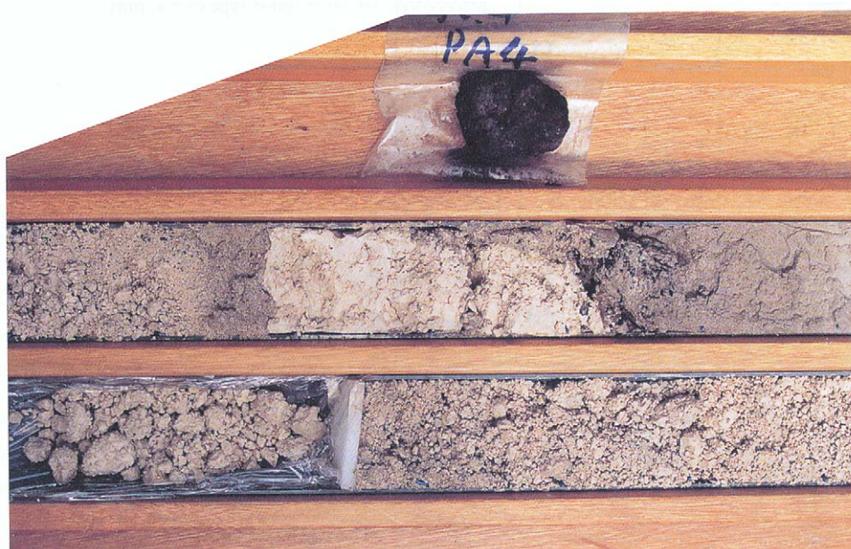
写真7 MR98 - 03, PC - 4コアの拡大図。石灰質軟泥 (0 - 30cm), チョーク (30 - 52cm) そして石灰岩 (52cm ~) からなる。明瞭な岩相境界が特徴的である。
