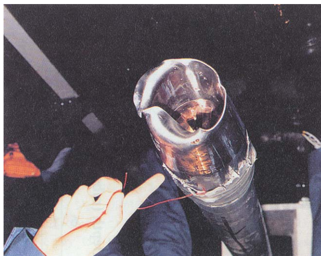
写真6 St. 4における採泥時に変形したコアラのビット Photo 6 A damaged corer bit during sampling in St. 4.
