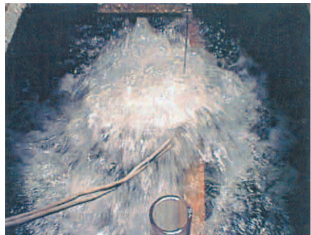
写真1 揚水特性実験(吐き出し部)
