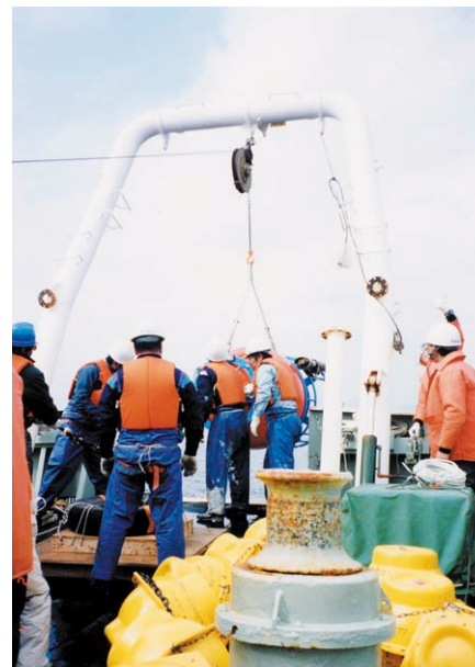
写真 9 係留系回収作業(4)：最後にトップブイを船上(後部甲板)へ回収している様子。
