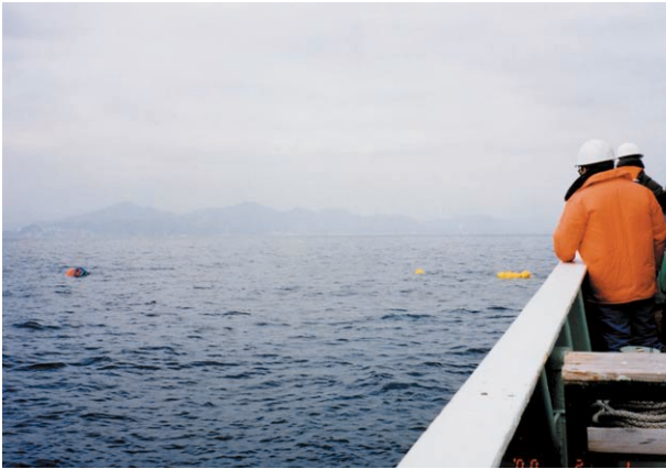
写真 6 係留系回収作業(1)：切離コマンドを送ったのち係留系が海面に浮上してきた様子。
