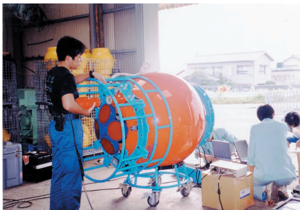
写真1 陸上試験：係留系に取り付ける前に、陸上において超音波多層流速計(ADCP)および音響モデムの作動試験をしている様子。
