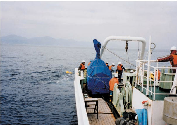
写真 7 係留系回収作業(2)：係留系を船上へ回収するため船を近づけている様子。
