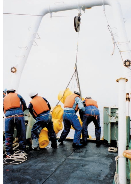
写真 8 係留系回収作業(3)：最初にガラス球ブイを船上(後部甲板)へ回収している様子。
