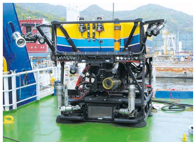
写真1 超高感度深海ハイビジョンカメラを装備した無人探査機「ハイパードルフィン」
