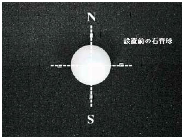
写真2 計測後の石膏球から卓越流向を求める方法の一例
