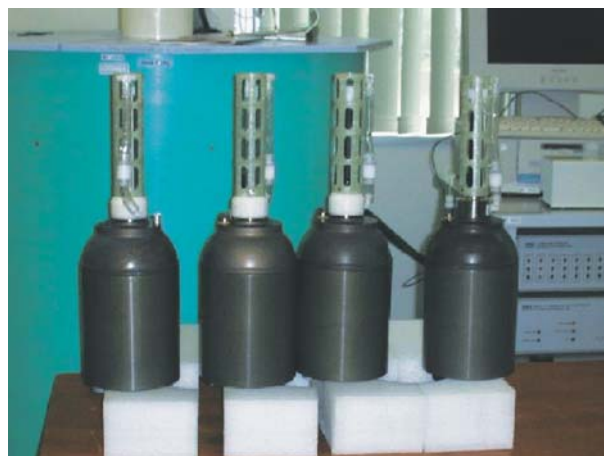
写真2 センサーを校正する前の状態。フロートから取り外したセンサー部を校正専用の容器に取り付ける。
