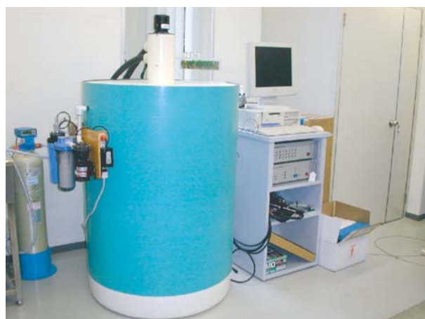
写真1 中層フロート搭載センサー校正用恒温水槽(校正バス) Photo 1 Argo float calibration bath (left) and controller (right).
