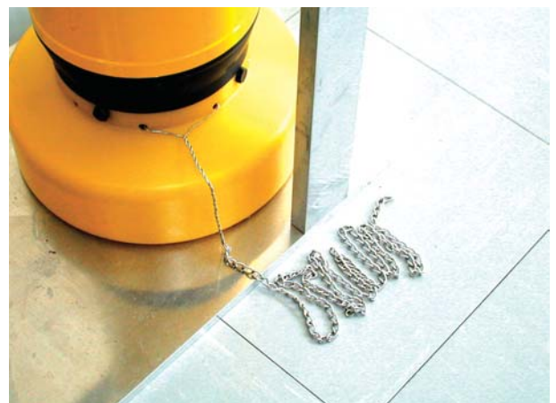
写真3 チェーンと治具 Photo 3 Chain with attachment to the float.
