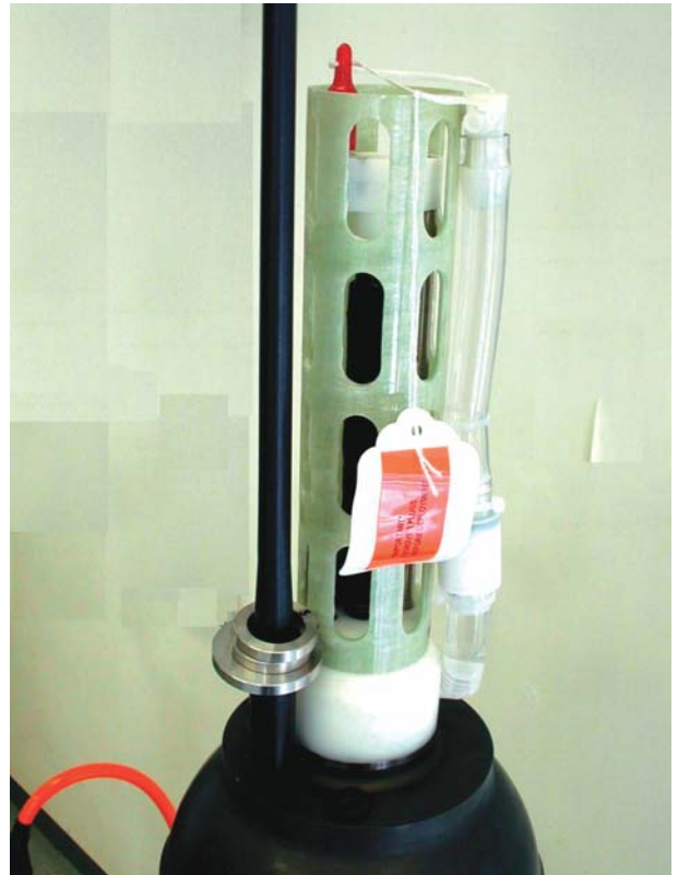
写真2 予備重量調整用ウェイト Photo 2 Weights for rough ballasting (rings put on the antenna).
