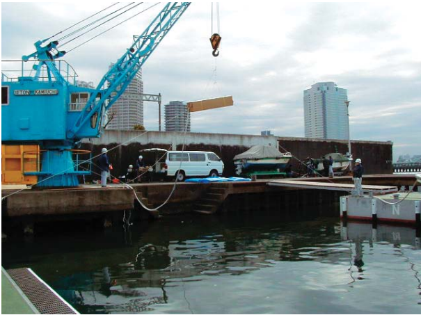
図6 実験の様子。緩衝容器を用いて5mの高さから落下させる場合。 Fig. 6 A photograph of the falling test. A case of 5-m height with the shock absorbing container.
