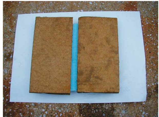
図9a 海水沈設後3時間での段ボール片の様子。左がワシントン大学製緩衝容器で用いられている段ボール片，右が日本製の段ボール片。
