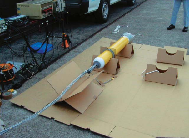
図4b 模擬フロートとセンサーケーブル。センサーからのケーブルがフロート先端部から出ている。組み立て前のワシントン大学製緩衝容器に設置したところ。
