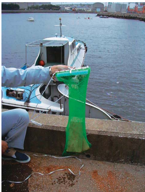
図8a 段ボール海水沈設実験に用いた小型網生け簀
