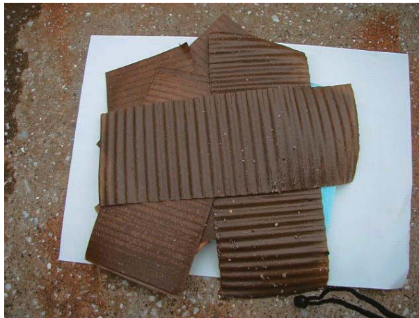
図9a 海水沈設後3時間での段ボール片の様子。左がワシントン大学製緩衝容器で用いられている段ボール片，右が日本製の段ボール片。
