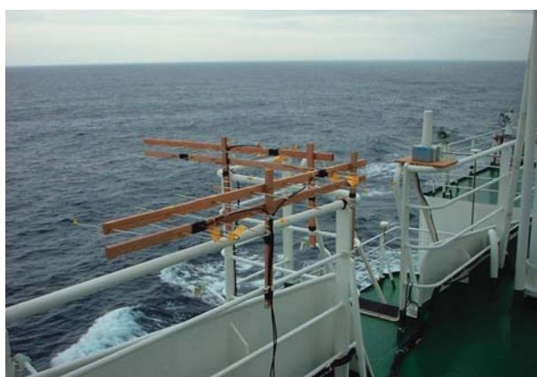
写真2 八木アンテナ。「みらい」のコンパスデッキ右舷側に設置したところ。 Photo 2 Yagi antenna set up on the starboard side of the compass deck of R/V Mirai.
