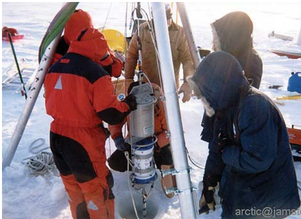
写真1 J-CAD 4設置時のWatson Compass及びWH-ADCPを水中に投入する時の写真
