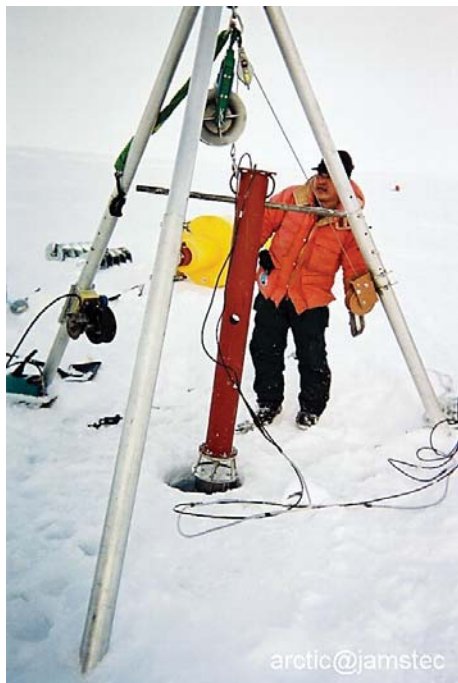
写真2 J-CAD 6設置時のWatson Compass・WH-ADCPをブイ本体とつなぐアルミ・フランジ
