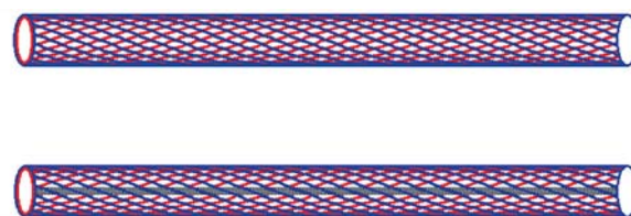
図3 ずれ防止機構を有するケーブル(上图)と一般ケーブル(下图) Fig. 3 Cable with slip restriction (Above Fig.) and normal cable (Below Fig.)
