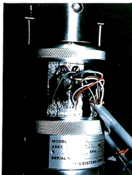
写真1 一軸圧縮試験供試体 photo. 1 Test piece for uniaxial compressive test
