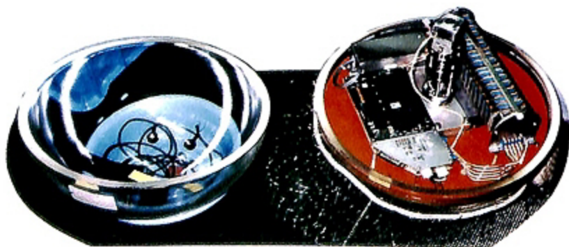
写真2 海底地震計の耐圧球とその内部。右側の半球の内、横に長いのがPROMメモリー、縦に長いのがセンサーレベル用のモーターユニット。
