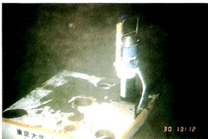
写真2 1988年10月30日に「しんかい2000」で観察された海底ベース1号機の設置状況。
