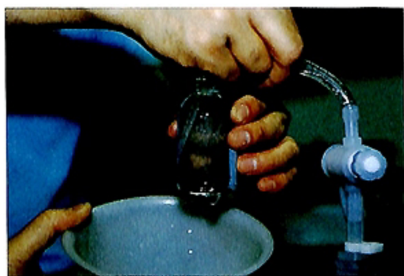
写真4 チタン採水器よりガラスバイアル瓶に分取されたブラックスモーカーの熱水。既に1リットルあたり5リットルSTPのガスを除いたにも拘らず尚発泡を続ける
