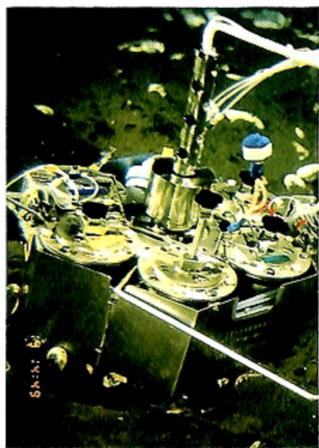
写真4 「しんかい2000」の第449潜航で相模湾初島沖の深海シロウリガイ群集中に設置中の潜水調査船用現場間隙水抽出装置 (ISPS-S)
