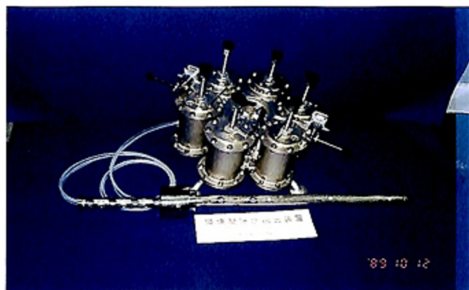
写真1 潜水調査船用現場間隙水抽出装置 (ISPS-S) の基本構造
