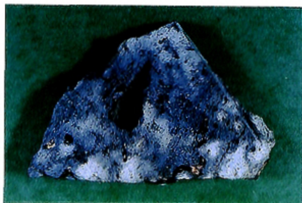
写真3 非晶質シリカでセメントされた火山砂試料の切断面 (試料368-1-2)。暗色部は非晶質シリカ, 白色部は石膏に富む。赤褐色部は砒素硫化物よりなる。試料長径5 cm。
