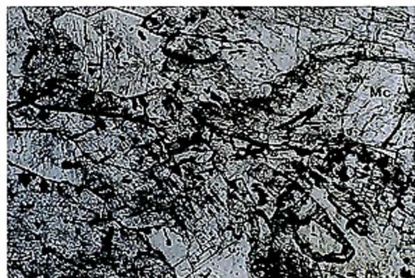
写真4 炭酸塩チムニー試料薄片の透過顕微鏡写真 (試料366-3-D)。粗粒マンガン方解石 (Mc) 中に鉱染する硫化鉱物。写真長辺 1.8mm。
