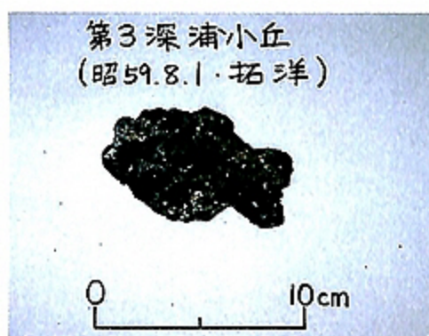
写真1 第3 深浦小丘付近で採取されたマンガン酸化物片
