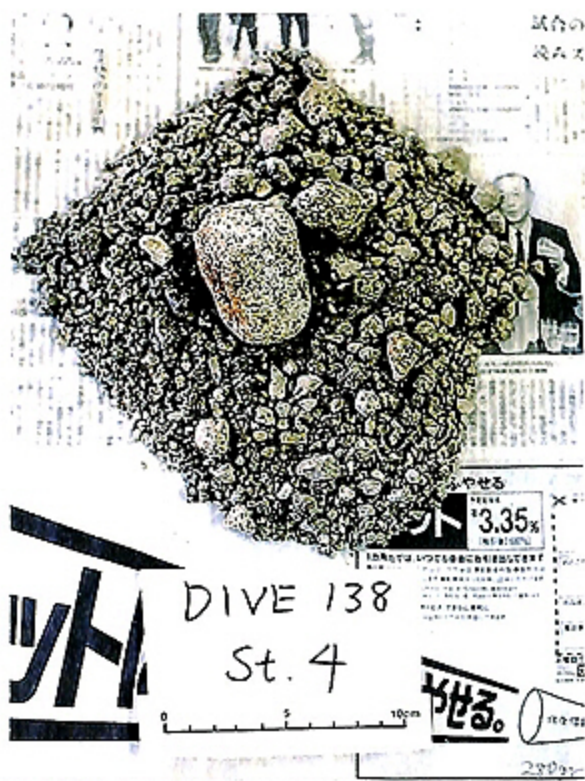
写真9 St.4から採取された底質（パミス質の砂礫） Photo 9 Bottom sediments (pumiceous gravelly sand) collected at St. 4.
