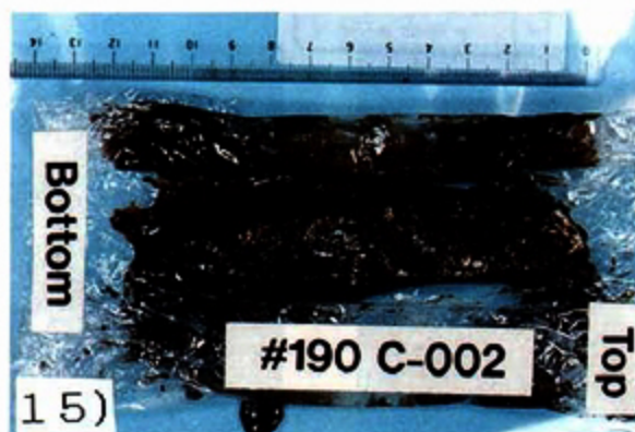
写真 15 石灰岩の表面に堆積した泥 Photo 15 Push core sample of surface mud covering limestone.
