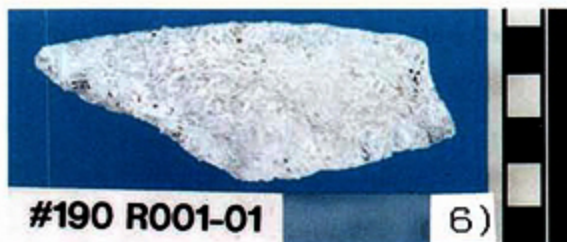
写真 6 カットした表面 Photo 6 Reefal limestone cut surface with many organisms.
