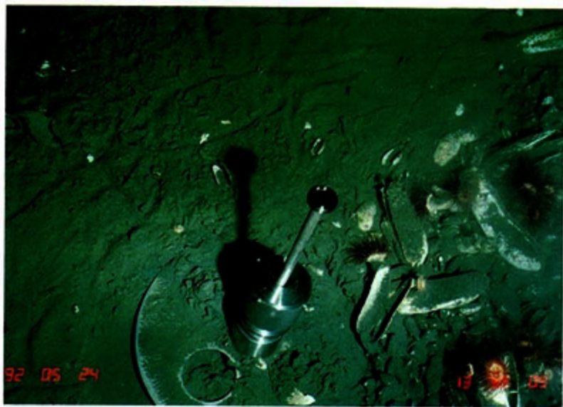
写真 1 コロニーの左側外で使用中の重錘打ち込み式コアラ-
