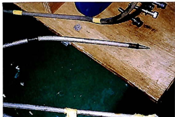
写真2 (上)設置された2番プローブ、(下)回収された2番プローブの一部。もともと黄色のビニールテープが黒く変色している
