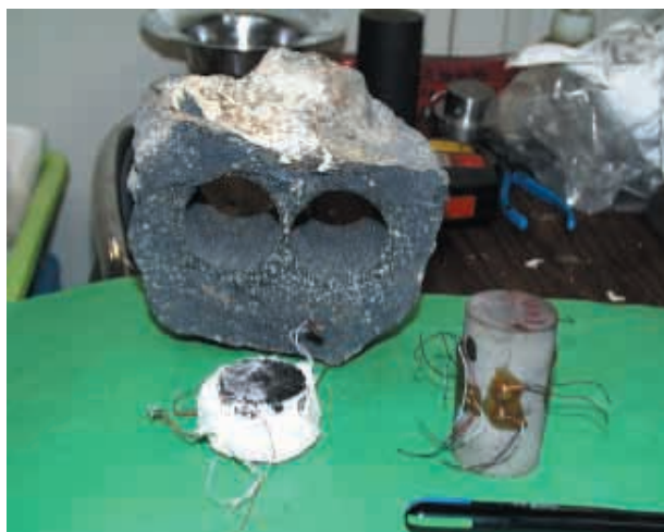
図12 セラミックス振動子を張り付けたコア試料 Fig.12 Core sample with oscillators for seismic wave velocity test.
