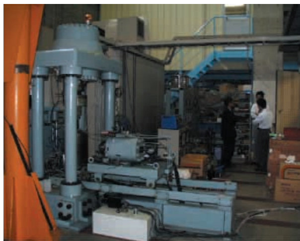
図13 地震波速度測定装置 Fig.13 Seismic wave velocity measurement apparatus.
