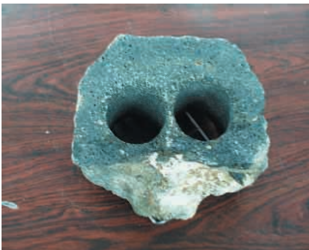
図11 ダイヤモンドコアドリルで試験用コアを採集した試料 Fig.11 Basalt sample R-1, after core drill.
