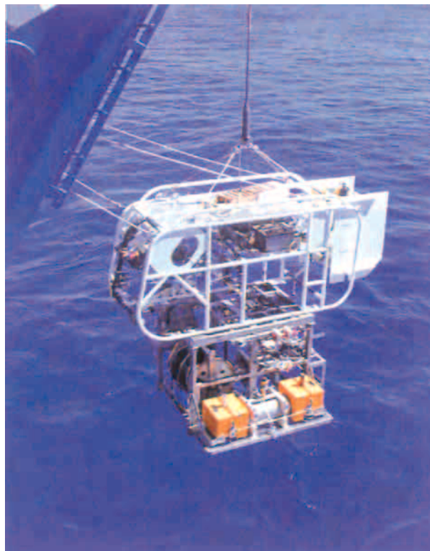
写真1 ディープ・トウカメラで設置中のマルチセンサ
