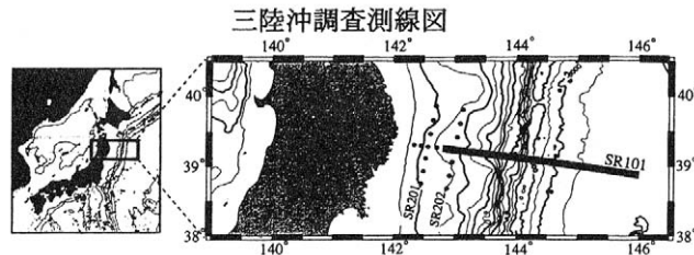
図11-1 調査船「かいれい」三陸沖航海の航跡図，太い線(SR101)は，MCS反射法探査の主測線を示し，黒い点は，海底地震計の位置を示す。SR201およびSR202は，OBS-Airgun探査のみ行った。
