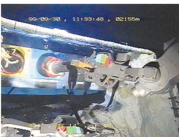
「かいこう」による分岐装置へのコネクタ接続の様子
